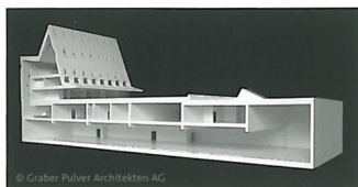
Blick ins offene Modell mit dem Eingangstrakt (links) und dem grossen, stützenfreien Saal (unten)
