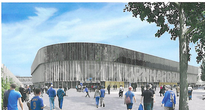
10-12 Unprätentiöse Robustheit: «Direkt verwandelt» von Gigon Guyer Architekten. Der Dachrand ist mit PV-Modulen bestückt, der eingezogene Sockel verkleinert die Grundfläche des Stadions. Dazwischen – vor dem «Stadt balkon» genannten Eingang – spannt ein Metallgeflecht mit dem Stadionnamen
