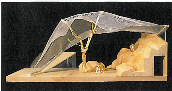
Ein Metallgitter spannt sich über die aus Burgerwäldern herbeigeschafften, ganzen Eichenbäume (1. Rang, Weber + Brönnimann / Graber-Pulver)
