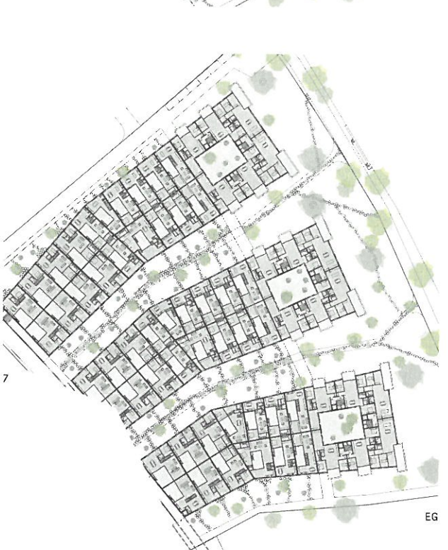
6-7 Antwort aufs Einfamilienhaus: dicht geschichtete Reihenhäuser mit Atrien. Höhere Kopfbauten mit Geschosswohnungen schliessen die Siedlung zum Fluss hin ab.
